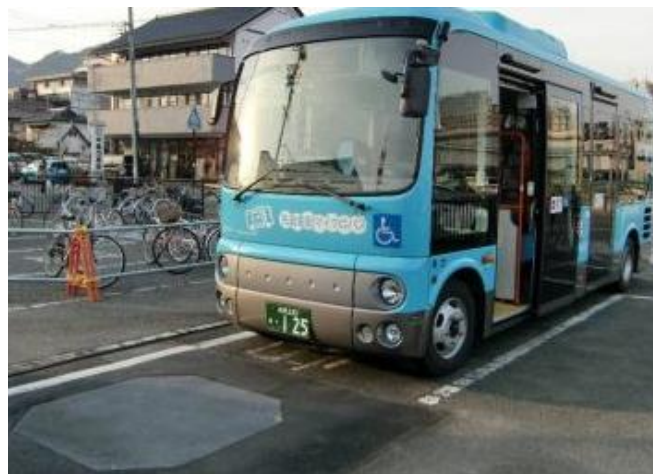
【写真 1】 WEB-4 の写真。バス前方の路面に非接触型充電装置(給電側)が埋め込まれている。(資料提供 早稲田大学)
