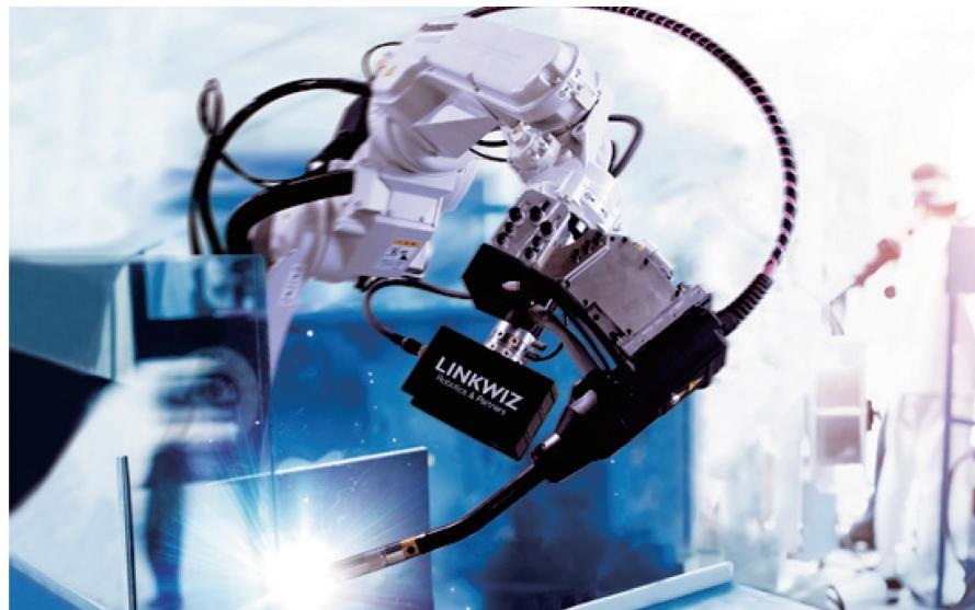
リンクウィズのシステムは、ロボットアームの先端に取り付けたスキャナと接続することで、加工対象（ワーク）の3次元形状を精密かつ短時間でデジタルデータに変換。取得したデジタルデータに独自の解析処理をすることで、ワークの外観検査や、ロボットによる溶接作業の自動補正などを行います。このため、産業用ロボットが従来苦手としてきた、ワークの位置ずれや、加工ばらつきによる溶接箇所のブレなどプログラムされていない事象への臨機応変な対応が可能になります。
