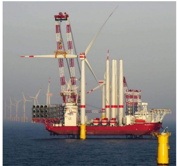
左：Zaratan 号（ザラタン号。秋田港・能代港における据付工事に導入予定。写真は台湾 Formosa1 Phase2 洋上風力発電所のタービン据付時。）
