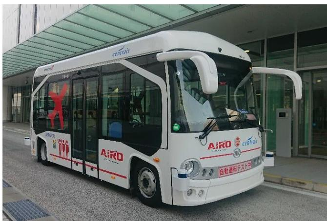
(\*) ZMP がバスによる乗客の輸送を想定して開発した自動走行バス「ZMP 製 RoboCar® Mini EV Bus」
