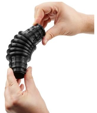
画像:ストラタシス TPU 92A エラストマー材料の大きな伸縮性と独特の弾性を持つモデル
