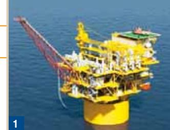
1 スーパー型浮体式洋上原油・ガス生産・処理設備
