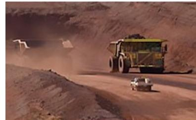
鉱石・土砂運搬に用いる大型ダンプトラック
