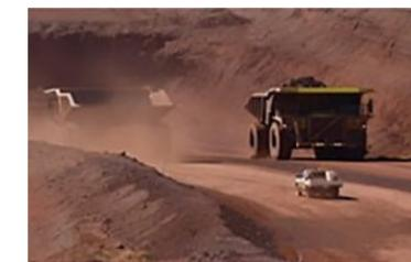
鉱石・土砂運搬に用いる大型ダンプトラック (豪州 ロイヤル鉄鉱山)
