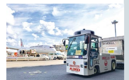
空港内実証実験にて使用した自動走行貨物牽引車
